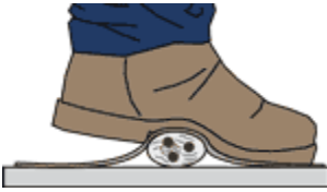
Fig. 39 Het verlengsnoer wordt beschadigd.
