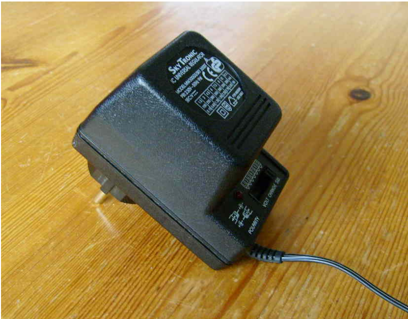
Fig. 53 Gestabiliseerde adapter. Merk: Skytronic. Model: MW300GS
