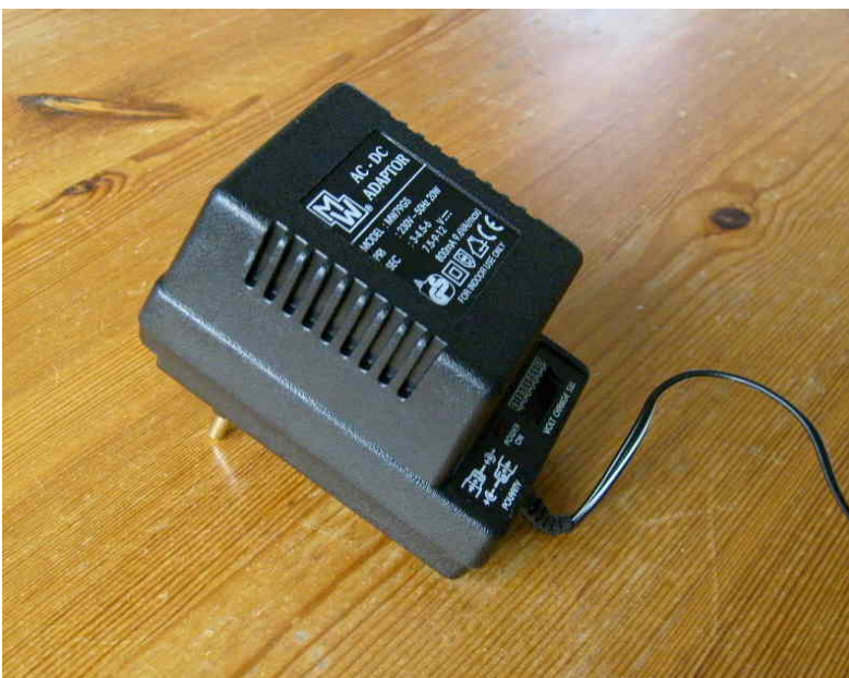
Fig. 52 Niet gestabiliseerde adapter. Merk: MW. Model: MW79GS
